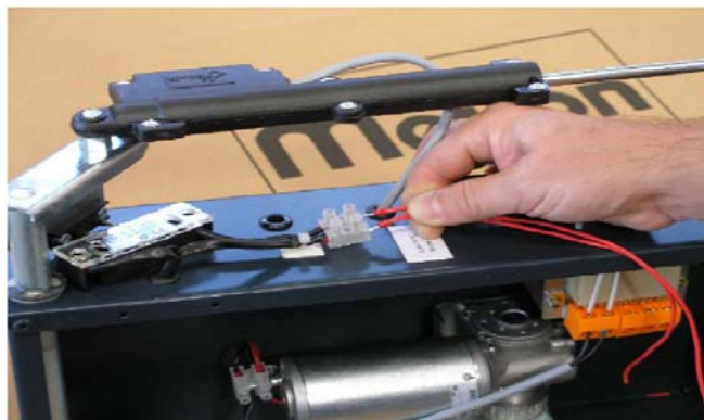
Obr.1 2-pinový konektor (svorky) pro připojení bezpečnostního spínače
